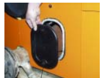
Крышка ревизионного отверстия для чистки
